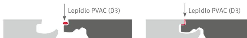
V priemyselných priestoroch musíte počítať s mimoriadnym vystavením vlhkosti. Z tohto dôvodu sa pri týchto aplikáciách predpisuje dodatočné utesnenie lepidlom na báze PVAC (D3). Tesniace lepidlo naneste na hornú stranu pera na kratšej aj dlhšej strane. Po spojení panelov by lepidlo malo vytiečť pozdĺž celej dlhšej a kratšej strany. Prebytočné tesniace lepidlo sa dá ľahko odstrániť z povrchu ihned alebo po krátkom zaschnutí.
